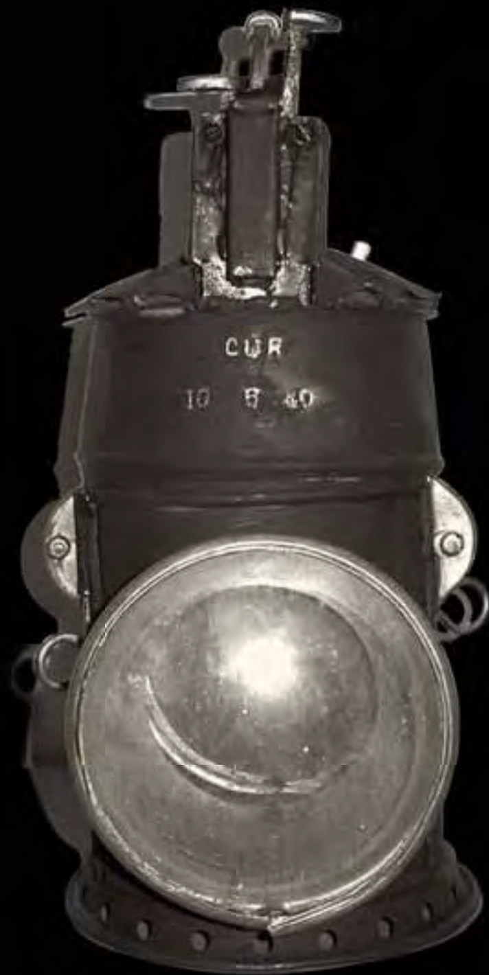
Farola de mano para realizar señales en la noche. Con ella se indicaba si los trenes podían circular (vía libre) o debían esperar. Posee tres vidrios que se intercambian: blanco, verde y rojo.
